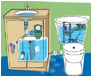
Figura 1: Sistema A – Reaproveitamento da água da pia na descarga. Disponível em < http://www.ecodesenvolvimento.org/noticias/sistemas-reutilizam-agua-da-pia-na-descarga-dos >, acesso em 15 de setembro de 2014. Adaptado.
