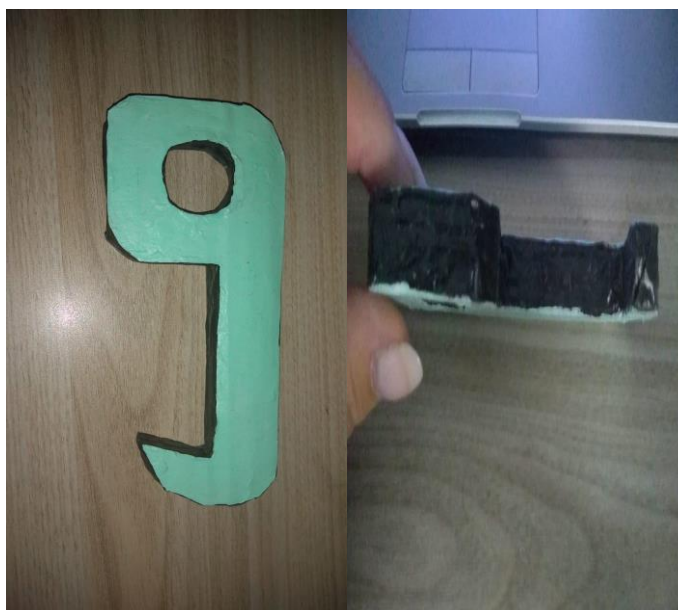
Figura 1: Dispositivo para abertura de portas sem a utilização das mãos, modelo gancho (Fonte: autores).
