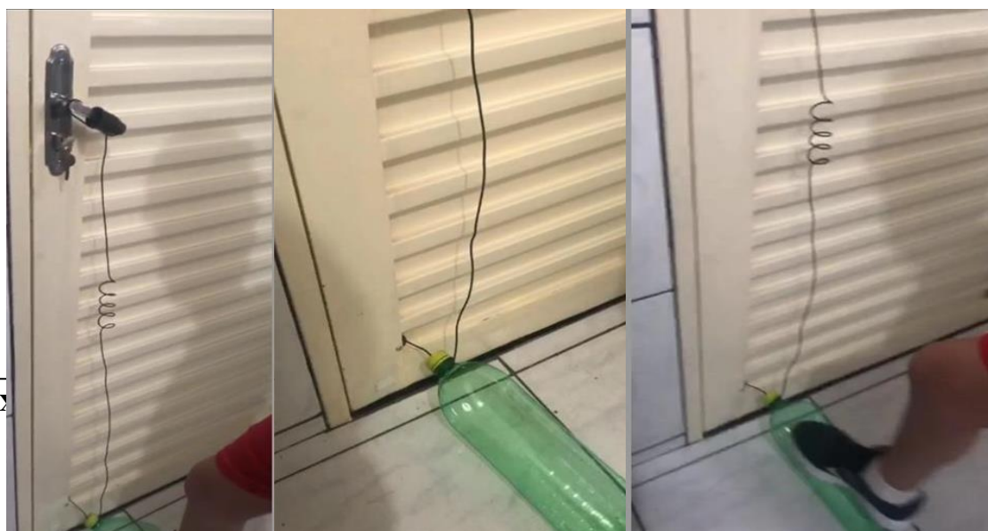
Figura 1: Dispositivo para abertura de portas sem a utilização das mãos, modelo gancho (Fonte: autores).
