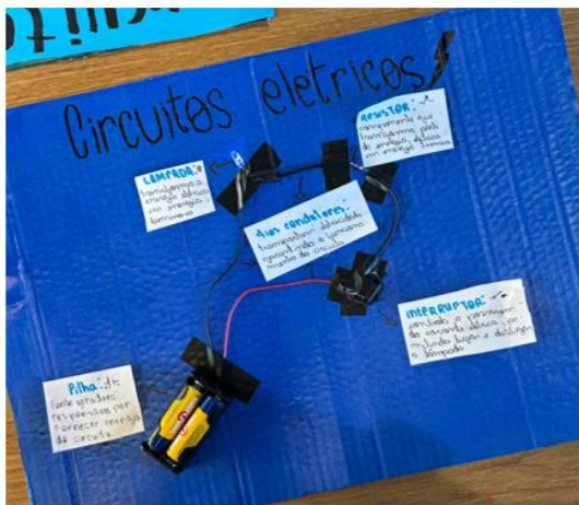
Foto 2: Circuito elétrico confeccionado pelos estudantes com a utilização de resistor, evidenciando os principais componentes (pilha, lâmpada, fios condutores e resistor) e suas funções no funcionamento do sistema. Fonte: autores.
