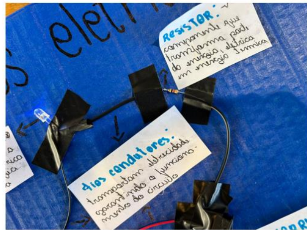
Foto 2: Circuito elétrico confeccionado pelos estudantes com a utilização de resistor, evidenciando os principais componentes (pilha, lâmpada, fios condutores e resistor) e suas funções no funcionamento do sistema. Fonte: autores.
