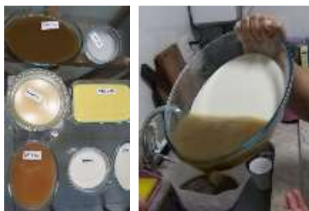
Figura 1: Processo de Decantação do Amido Extraído e Retirada do Substrato Líquido do Amido.
