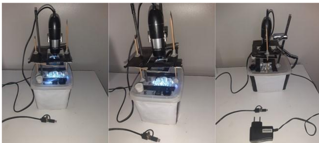
Figura 1 - Microscópio digital adaptado por meio de materiais recicláveis: vistas frontal e lateral.
