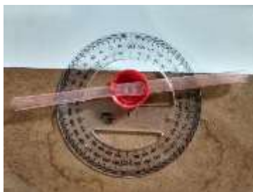
Figura 1: Teodolito caseiro confeccionado por aluna.
