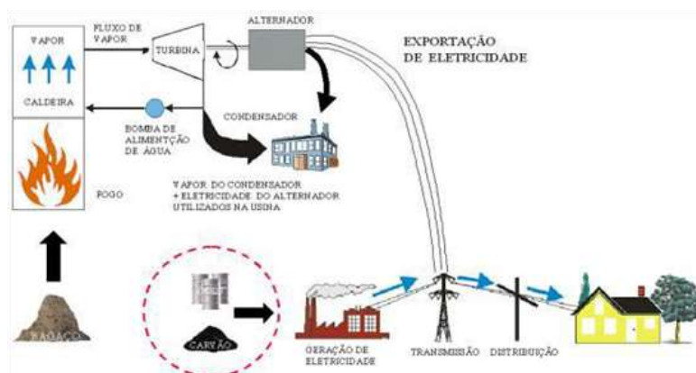
Figura 1: Diagrama de Geração de Energia a partir do bagaço de cana-de-açúcar da Usina Açúcar Guarani. Fonte: http://www.guaranifm.com.br/responsabilidade/ambiental.php?nSubTopicoN2=3
